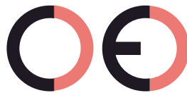
Marca CE falsa (demasiado separados)
